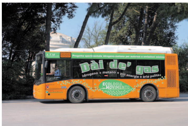
FIG. 22 - Autobus a miscela idrogeno-metano
